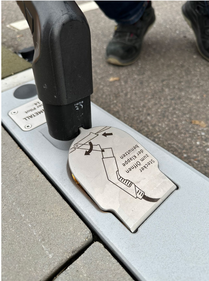
Abb. 53: Einhandbedienung zum Öffnen der Verschlussklappe
