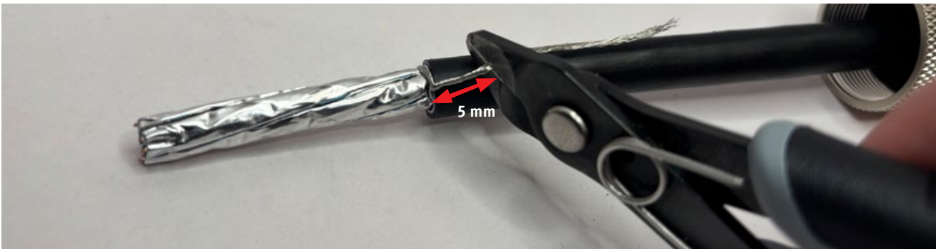
Abb. 31: Schirmung nach hinten führen und auf 5 mm kürzen
